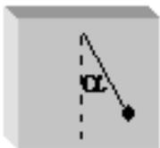
17) Una pequeña esfera de masa  $m = 3,0 \times 10^{-3} \text{Kg}$  cargada con  $1,5 \times 10^{-6} \text{C}$ , cuelga de un hilo aislante, fijo por su extremo a una gran superficie vertical cargada uniformemente con  $\sigma = 1,26 \times 10^{-7} \text{C}/\text{m}^2$ ). Calcule el ángulo que forma el hilo con la superficie cuando se alcanza el equilibrio.
